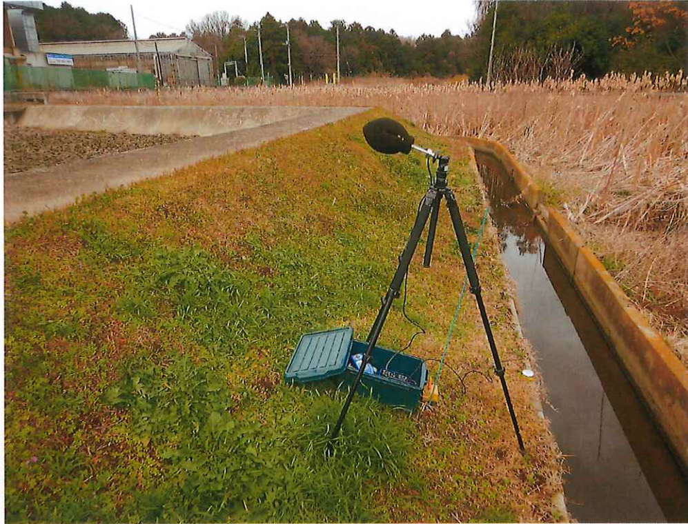
敷地境界 No.1 騒音レベル及び振動レベル測定状況
