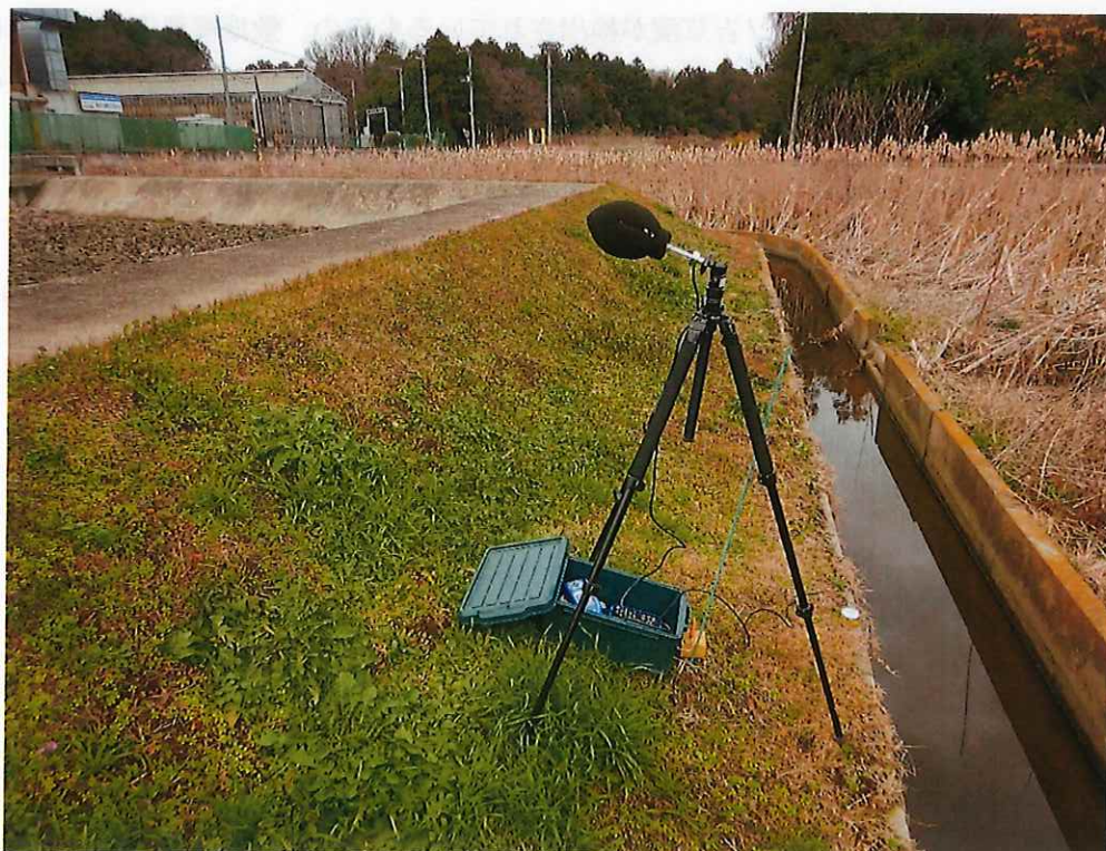
令和5年12月19日～20日 騒音レベル及び振動レベル 敷地境界 測定状況
