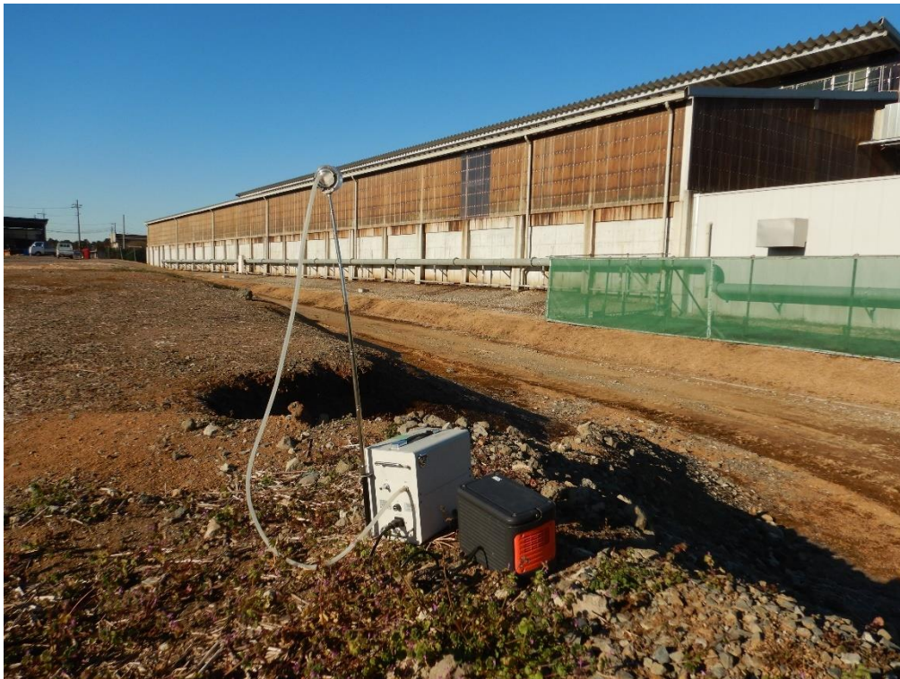
令和7年1月14日 粉じん濃度 敷地境界(風下) 測定状況
